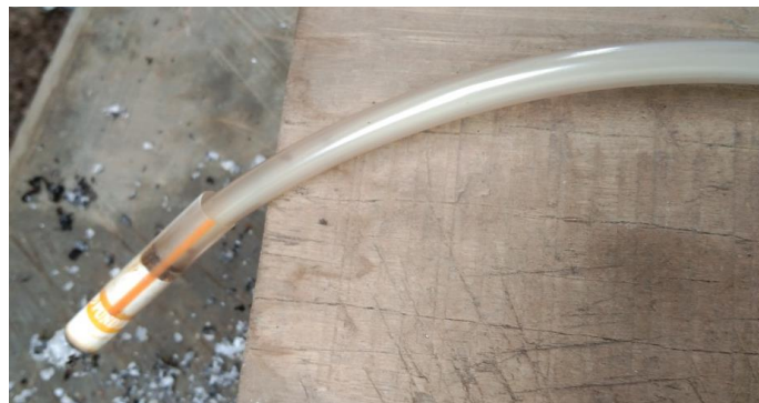
Gambar 4.7 Asap rokok masuk melalui selang yang berfungsi sebagai mulut dan tenggorokan
