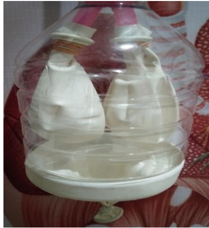
Gambar 4.10 Dua balon mengempis pada saat balon besar dilepas
