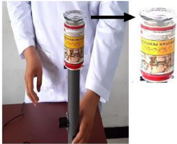
Gambar 2. Potongan alumunium foil ditaruh diatas kepala GVG.
