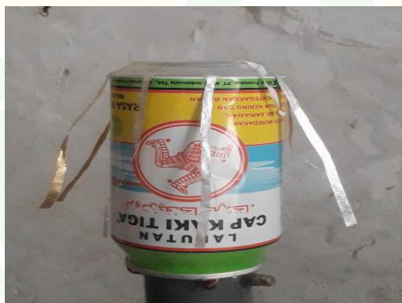
Gambar 4.10 Sesudah direvisi (GVG dengan aluminium foil)
