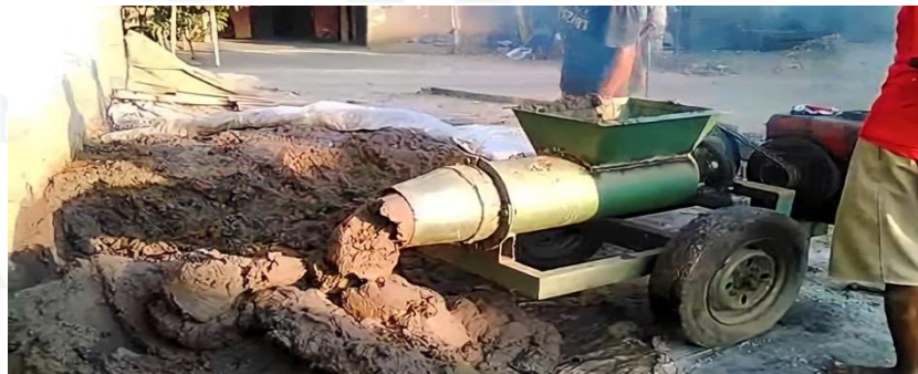
Proses melunakkan atau mengencerkan tanah menggunakan mesin luluh batu bata
