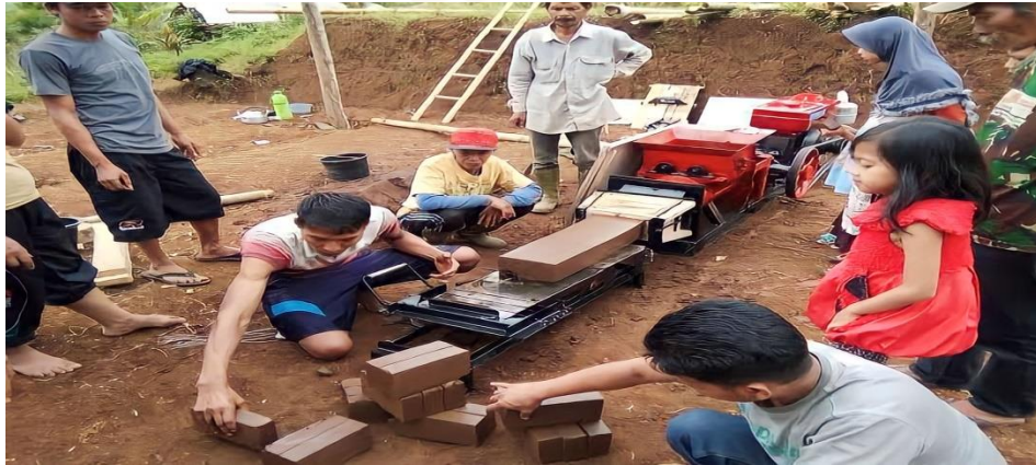
Proses pencetakan dan pemotongan batu bata menggunakan mesin cetak batu bata
