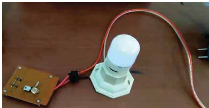
Gambar 4 Lampu otomatis sensor cahaya saat ditempatkan di ruangan terang
