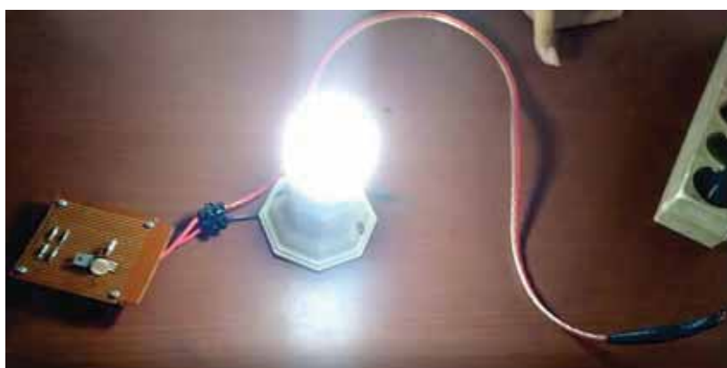
Gambar 4 Lampu otomatis sensor cahaya saat ditempatkan di ruangan gelap
