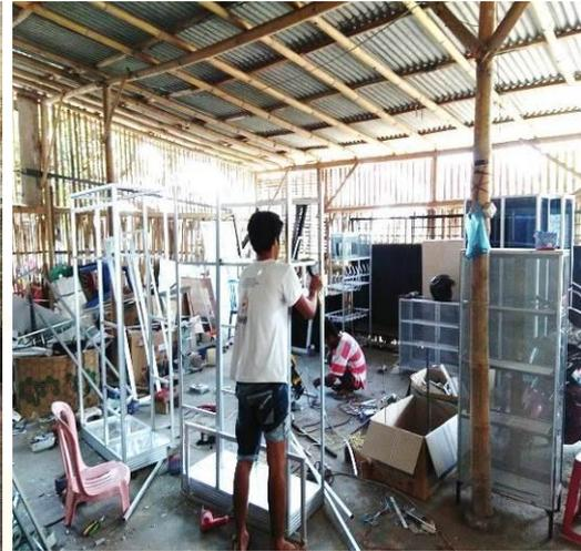
Foto proses produksi almari dan rak piring aluminium.
