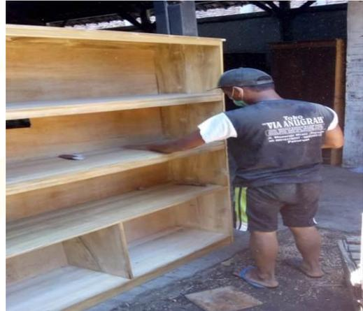
Foto proses menghaluskan loker almari kayu sebelum dicat dengan mesin *spray*.
