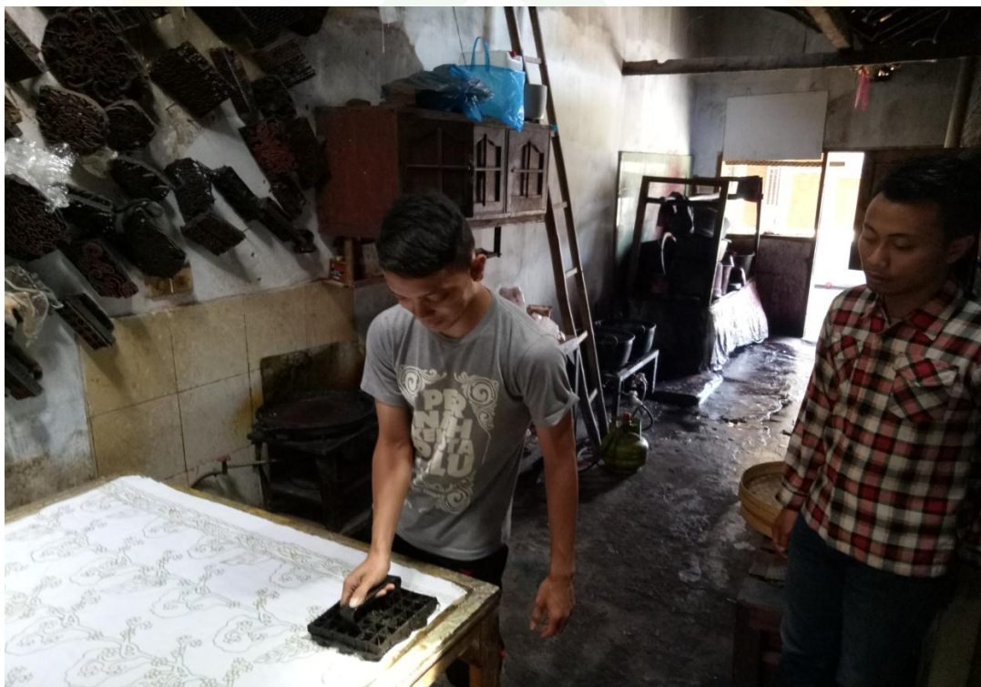
Proses Pengecapan Motif Batik Menggunakan Alat Cap pada Kain
