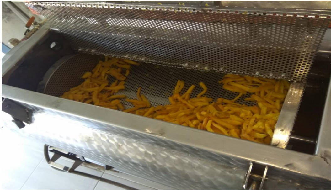
Proses Pengolahan Keripik Tape Menggunakan Vacuum Frying, 2 Mei 2019.
