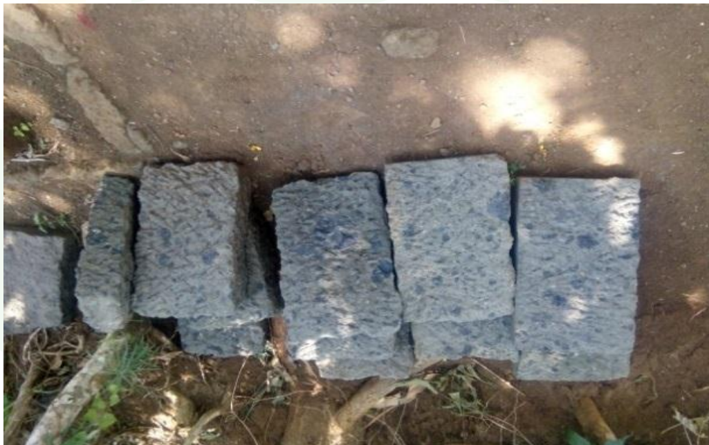
foto: hasil galian batu padas setengah jadi menggunakan mesin
