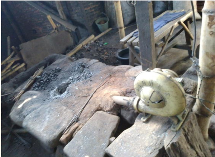
Blower dan Tungku
