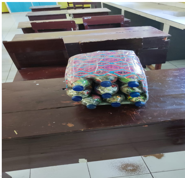
Gambar 4.5 Pembuatan ecobricks dari botol yang berisi plastik Menjadi kursi
