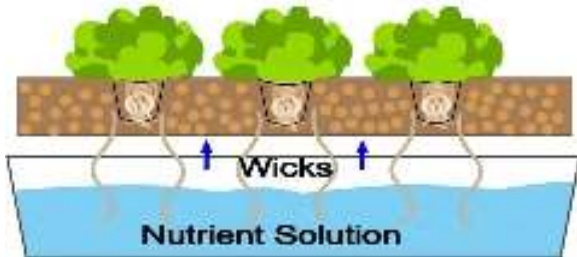
Gambar 4.8 Ilustrasi hidroponik menggunakan sistem wicks.
