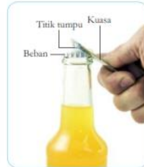
Gambar 3.15 Alat pembuka botol, contoh pengungkit jenis 2 Sumber: shutterstock.com/DfTaylor
