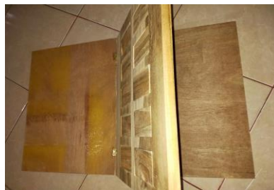
Gambar 4.4 Menggabungkan papan kayu dan papan triplek menjadi 1 bagian
