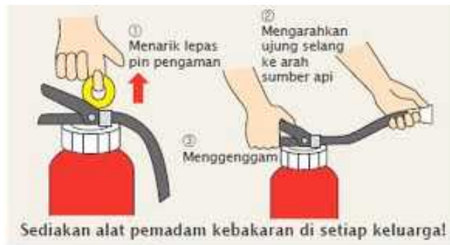
Gambar 36. Teknik PASS pada Alat Pemadam Portable
