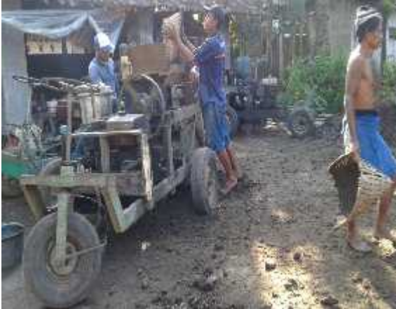
Proses penggilingan tanah
