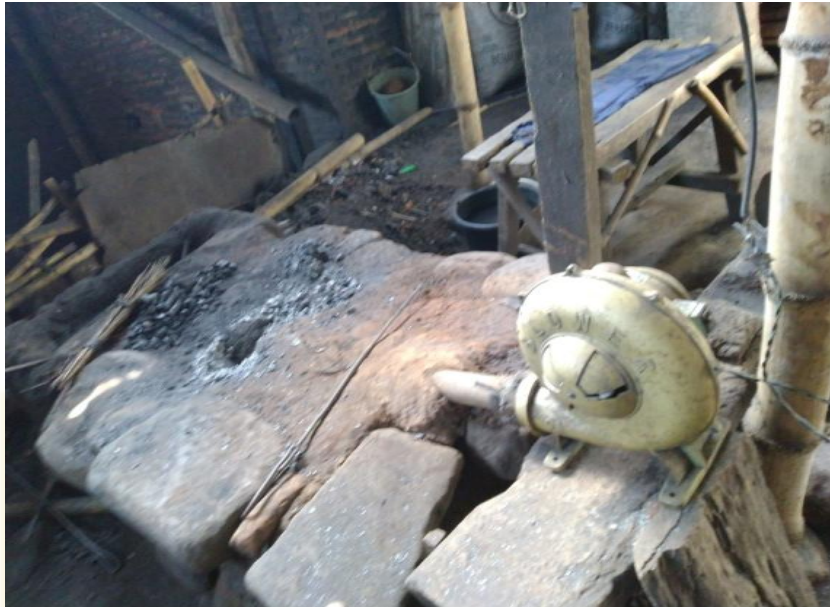
Blower dan Tungku
