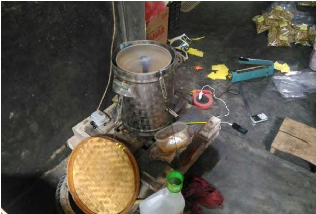
Proses Penirisan Sale Pisang Barlin Menggunakan Mesin Spinner
