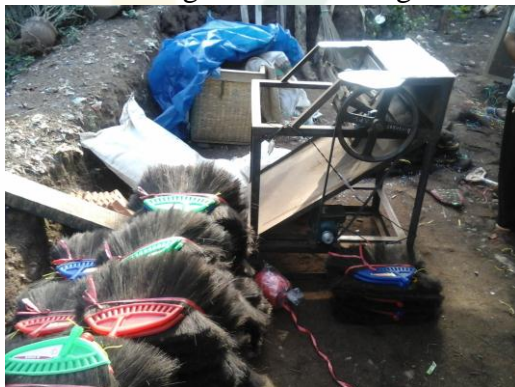
Foto Mesin Sisir Sapu Ijuk Pada Saat Proses Penghalusan Ijuk.
