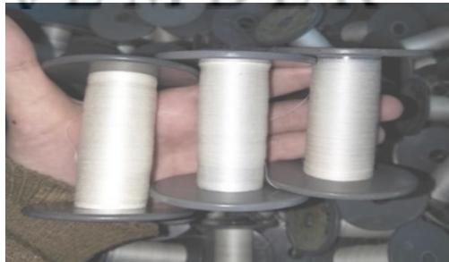
**Gambar 2.14 Foto Alat Bobbin / Kletekan, tempat menggulung benang setelah melalui proses pengelosan agar tidak lecek**
