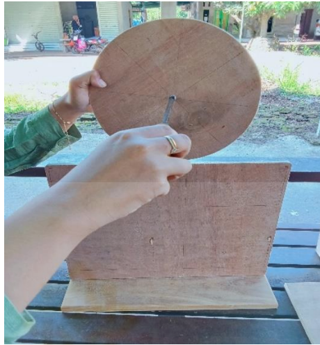
Gambar 4.8 Proses merekatkan roda dengan kayu tiang menggunakan baut mur dan obeng
