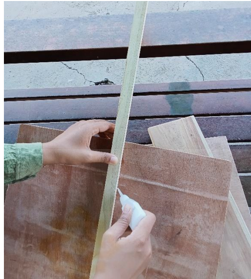
Gambar 4.6 Proses merekatkan triplek dengan kayu tiang Menggunakan lem
