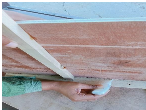
Gambar 4.7 Peroses merekatkan triplek dengan kayu bawah sebagai alas
