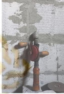
**Gambar 3. 23 Hand Bor untuk mebuat klanti**
