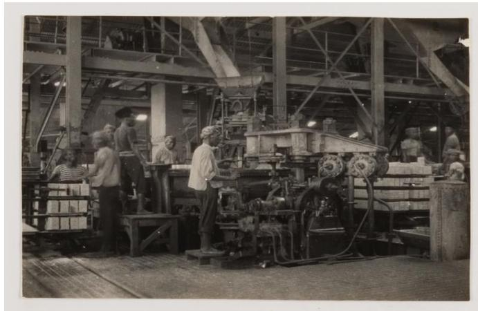
**Gambar 2.5** Proses pembentukan garam briket
