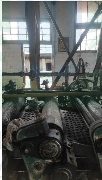
**Gambar Lampiran 4. Mesin pemotong endapan karet menjadi lembaran-
