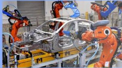
Gambar: Robot otomatisasi pembuatan kerangka mobil.
