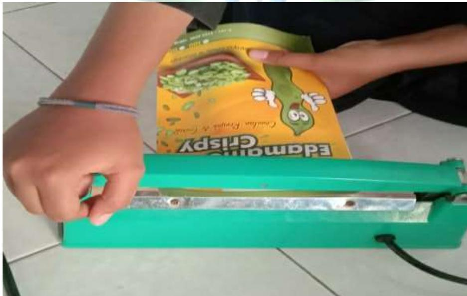
Proses pengemasan edamame menggunakan mesin press
