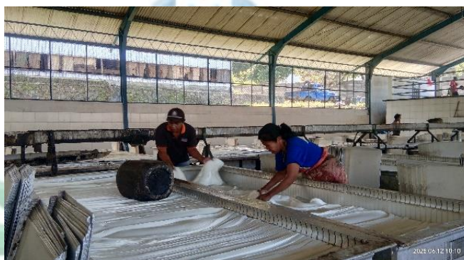
Gambar 4.4 Proses pemasangan getah yang sudah dicampur ke loyang aluminium ber-skot.
