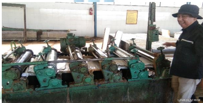
Gambar 4.5 Mesin giling five in one, mesin lima gilingan dengan dua roda penggerak.
