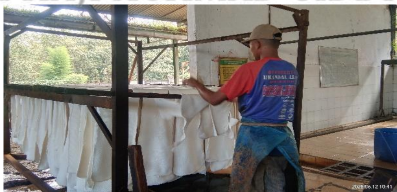
Gambar 4.6 Proses penggantungan sheet .
