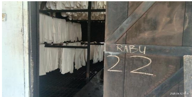
Gambar 4.7 Proses penyimpanan sheet di ruangan pengasapan, guna memperkuat daya tahan sheet .
