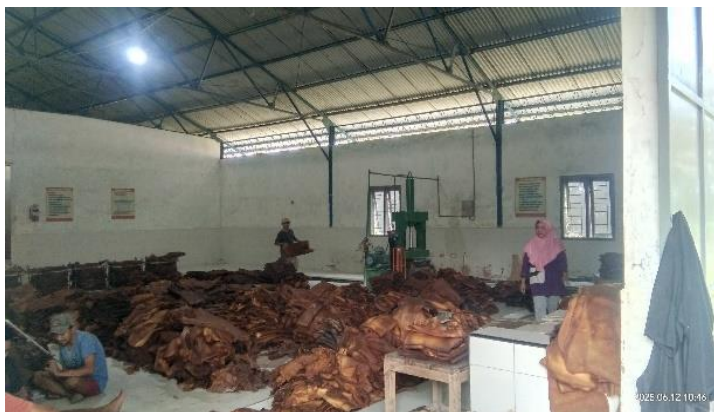
Gambar 4.8 Proses sortasi yang dilakukan secara manual pada sheet yang sudah melewati proses pengasapan.
