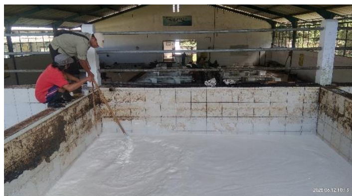
Gambar 4.2 Proses pengaliran getah karet dari tangki ke talang keramik dan dicampur dengan air.
