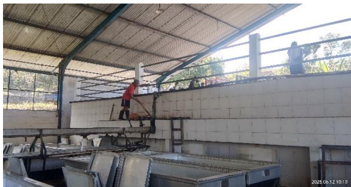
Gambar 4.3 Proses pencampuran getah karet dengan asam semut.
