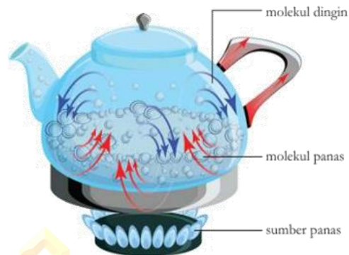
Gambar 2. 6 Arus Konveksi Dalam Cairan Yang Dipanaskan
