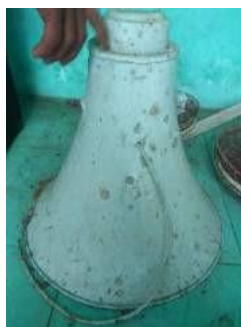
Gambar 7 Speaker Corong di Masjid Al-Amir yang Rusak
